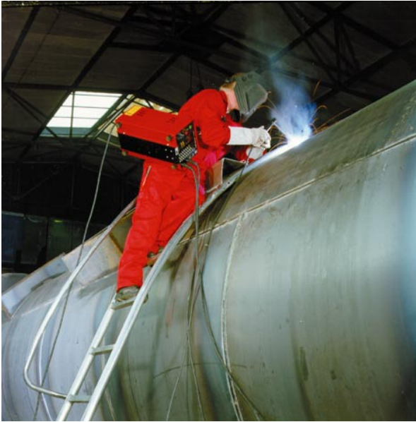
Bild 21 Anwendung des E-Hand-Schweißens im Behälterbau
