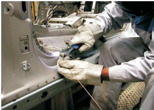
Bild 22: Manuelles Plasmalöten am Türschweller einer BMW-PKW-Karosserie
